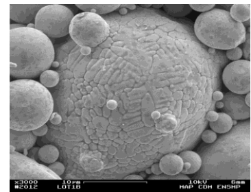
Image MEB de particules de poudre d'un alliage base cobalt
